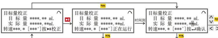
这里目标量校正的过程实际上是校正“转速”，先按设置的“运行时间”和计算出的转速运行，结束后将实际测量的数值输入并确认，设备会计算出完成目标量所需准确的“转速”，校正完成。校正过程可反复进行。
