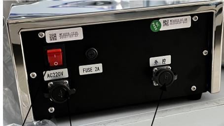
电源开关 电源接口 外控接口
