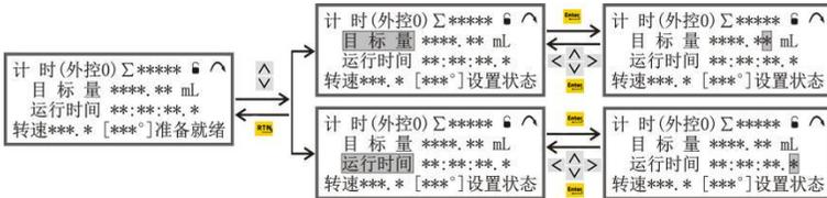
输入方法同手动/自动方式。“在外控1”时，“目标量”和“运行时间”也可以用通讯的方法进行设定。
