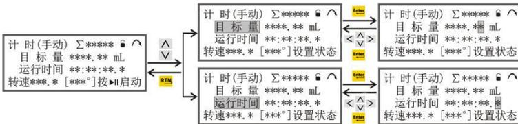
按 **^** 键或 **v** 键再按 **Enter** 键选择目标量参数, 此时目标量参数末位数字反白, 按 **<** 键或 **>** 键选择调节步进位, 按 **^** 键一次, 步进位数值上调 1, 按 **v** 键, 步进位数值下调 1, 直至调节数值至所需值, 再按 **Enter** 键确认。同样的方法可设置运行时间。设置完成后按 **RTN** 键返回“计时”工作界面。
