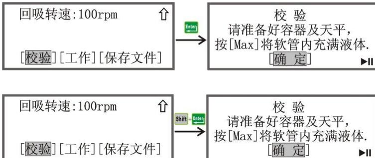
按提示准备可以容纳目标装量的容器及可称量目标装量的天平，按 **Max** 键将软管内充满液体，并确保软管内无气泡。然后按 **Enter** 键进入下一层菜单。装量校验界面按 **▶||** 键，泵校验一次如下图。若已经知道了实际装量，可以按 **Enter** 键后直接输入实际装量值。
