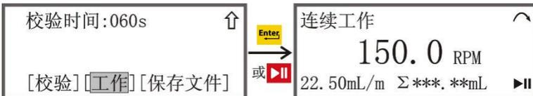
**150.0RPM:** 根据设置的流量和软管及软管通道数生成的泵需要运行的转速，或设置的转速。
